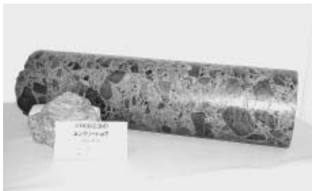
浦山ダムのコンクリートコア（テストピース） 水資源開発公団 荒川ダム総合事務所蔵
