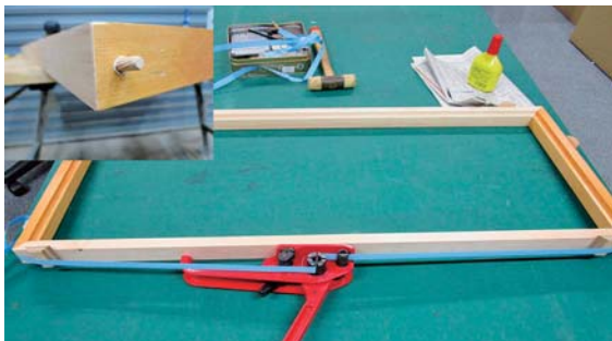
写真5. 額フレームの接着のためPPバンドで締められている。左上はダボで固定した状態
