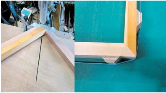
写真4. 額フレームのコーナー。45度切断の治具とコーナー接着のための治具
